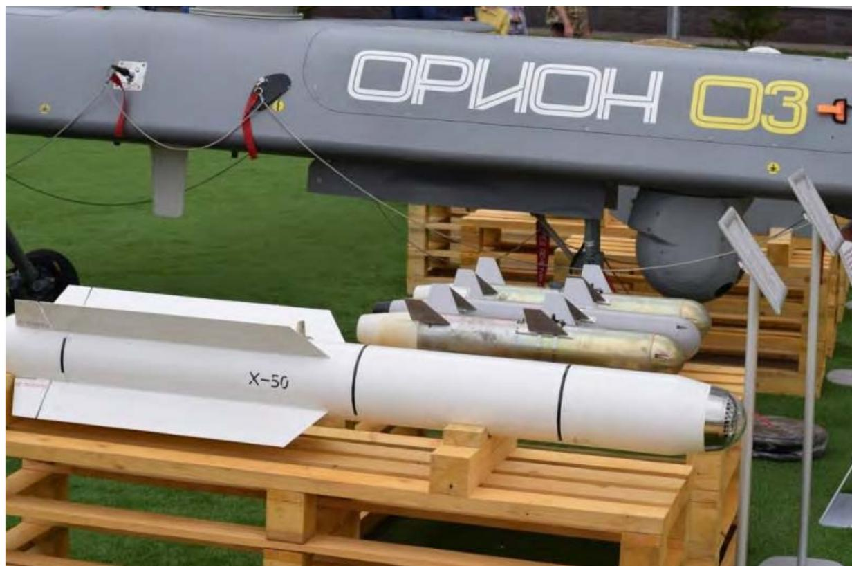
«Орион» и его оружие на «Армии-2020». На переднем плане ракета X-50, за ней бомбы КАБ-20. Источник: bmpd.livejournal.com
